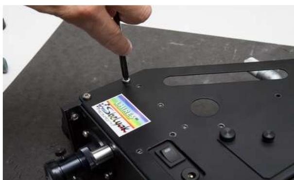
Lorsque toutes les vis sont démontées, le flasque doit pouvoir sortir librement.
