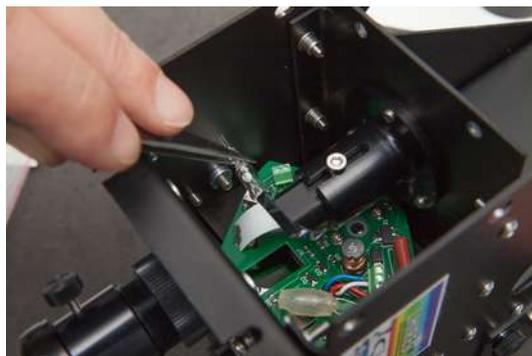
Lorsque la nouvelle ampoule est en place, resserrer le bornier, et faites un test de la lampe (en alimentant le module) avant de remonter la platine télescope.
