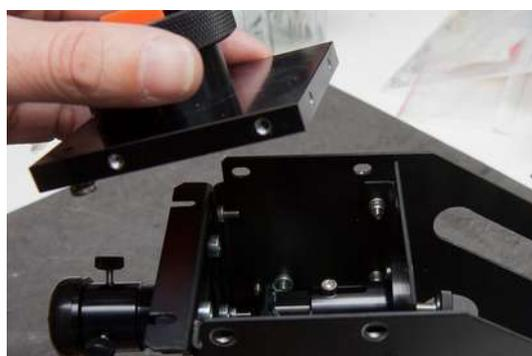
Démontez la platine de fixation sur le télescope, fixée par 8 vis M4. Notez que les deux vis **sous** la platine peuvent être seulement desserrées.
