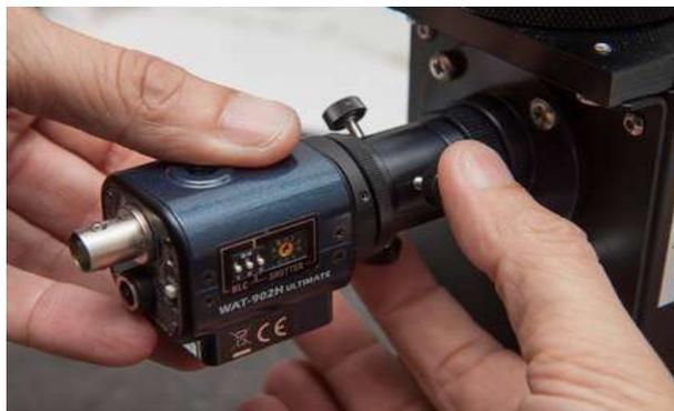
Lorsque la mise au point est correcte, bloquez l'écrou moleté.
