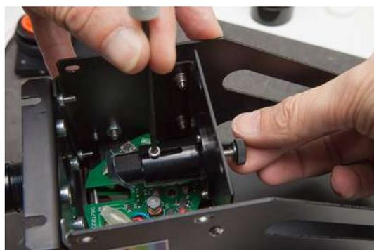
Regardez l'effet de ce mouvement sur l'image de guidage : l'image de la fente se déplace-t-elle dans la bonne direction ? Si oui, alors poursuivez jusqu'à ce qu'elle soit bien centrée. Dans le cas contraire, tournez la vis centrale dans l'autre sens, et plaquez le support de miroir dans la direction de la vis (en utilisant le tournevis).
