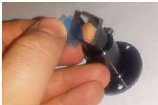
Mettez ensuite en place le nouveau miroir de guidage. Veillez à orienter correctement le module : le miroir doit regarder vers le bas du Lhires III, et la vis de réglage doit être tournée vers l'entrée du spectroscope.
