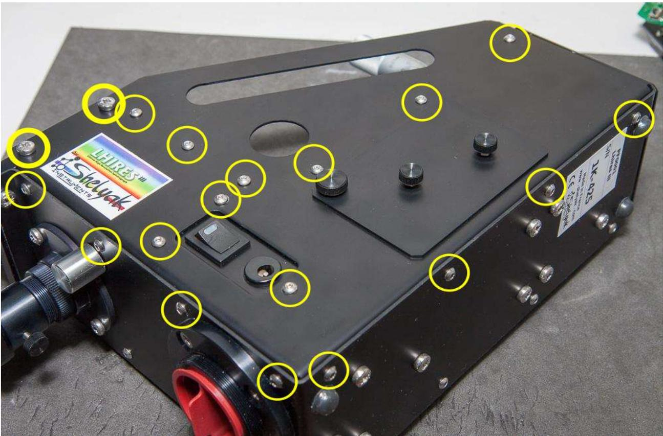
Puis commencez par serrer les deux vis dans l'angle du châssis près de la caméra d'acquisition.
