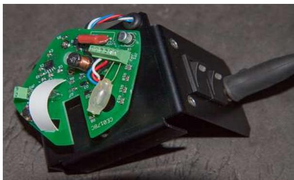
**Note** : Il se peut que dans certaines positions, ou si vous essayez de bouger à la main le module lorsqu'il est sous tension, vous entendiez un grésillement. C'est signe que le servo-moteur qui entraîne le circuit imprimé mobile ne peut pas aller à sa position attendue sans effort. C'est généralement le signe qu'un fil frotte quelque part ou qu'un obstacle empêche le mouvement naturel du circuit. Dans ce cas, regardez avec attention la partie qui gêne et corrigez-là.
