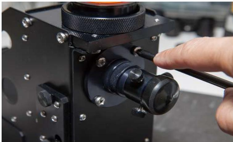
Si vous remplacez **également** le module d'étalonnage, utilisez les vis M4x6mm fournies pour remonter le nouveau module.
