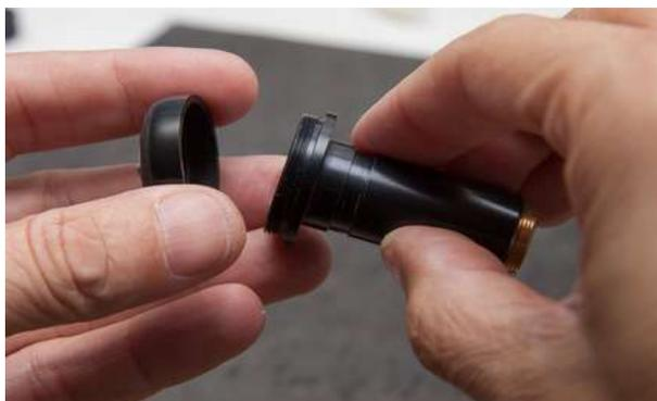
Visser le coulant sur votre caméra en prenant soin de ne pas mettre les doigts sur la lentille à l'extrémité du coulant. Serrez fermement (et sans excès).
