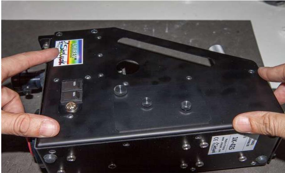
Remettez les 14 vis M3 en place, d'abord sans les serrer (pour que chacune trouve bien sa place). Commencez par placer les trois vis du module d'étalonnage
