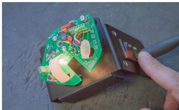
Vous pouvez également vérifier que si vous actionnez les deux interrupteurs en même temps, aucune lampe n'est allumée, mais le circuit imprimé reste en position « flat » (lampe blanche). C'est dans cette position que vous pourrez
