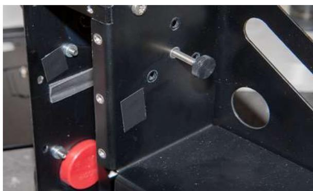
**Retirez délicatement le film de protection du miroir de guidage (film bleu ou rose le plus souvent), en veillant à ne pas mettre de trace de doigt sur le miroir (cf photo suivante).**
