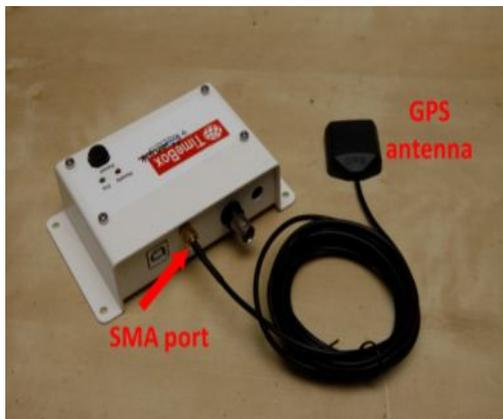
Connecter l'antenne GPS au port SMA de votre TimeBox. Placez l'**antenne externe à l'extérieur** avec une vue claire et ouverte du ciel.
