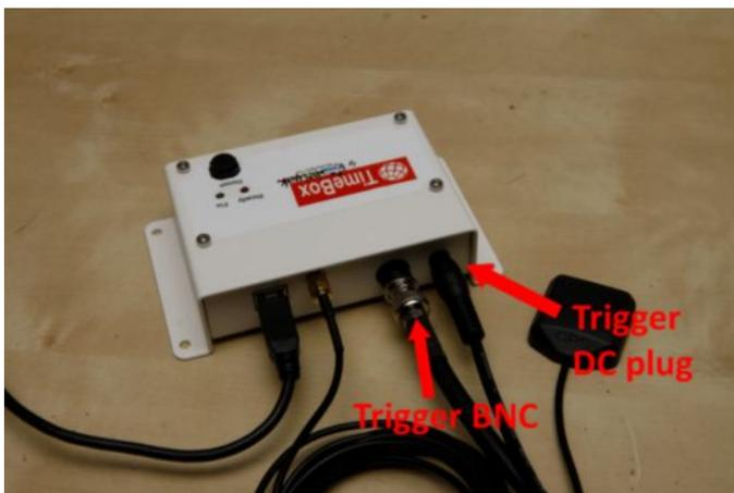
Connectez la sortie **Trigger BNC** au port E/S de la caméra et l'alimentation 12 V DC à la fiche TimeBox DC.
