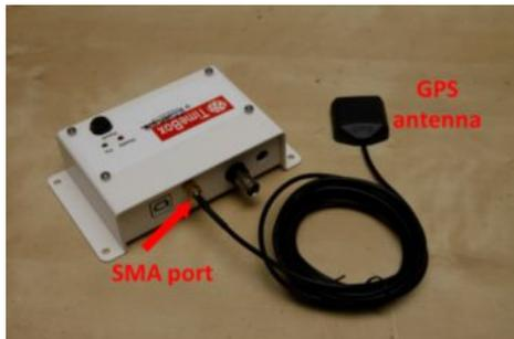
Connectez l'antenne GPS au port SMA de votre TimeBox. Placez l'**antenne externe à l'extérieur** avec une vue claire et ouverte du ciel.
